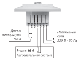
Рисунок 4. Схема подключения к терморегулятору
